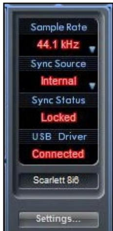
La section Statut d'appareil affiche des informations sur la fréquence d'échantillonnage, la synchronisation et le statut de pilote de la Scarlett 8i6. La fréquence d'échantillonnage désirée peut être réglée ainsi que les options de synchronisation externes pour l'emploi de la Scarlett 8i6 avec des appareils numériques externes.
