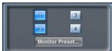
Les boutons d'activation de la commande Monitor indiquent quelles sorties sont contrôlées par la section Monitor de l'interface graphique utilisateur sous les quatre boutons. La Scarlett 8i6 peut être configurée pour qu'il y ait un contrôle de niveau de volume et que selon la configuration d'écoute, le niveau envoyé à une simple paire d'enceintes ou à jusqu'à quatre enceintes puisse être simultanément contrôlé.
