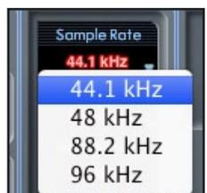
Affiche la fréquence d'échantillonnage à laquelle fonctionne actuellement la Scarlett 8i6. Pour la changer, cliquez sur la valeur rouge et sélectionnez 44.1 kHz, 48 kHz, 88.2 kHz ou 96 kHz.
