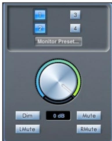
Les niveaux des sorties Monitor et casque sont configurés en section Monitor. La Scarlett 8i6 peut être configurée pour que l'audio envoyé aux sorties ligne soit contrôlé par la molette de volume du logiciel, soit indépendant de la molette de volume du logiciel, ou soit coupé.
