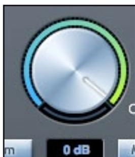
Le niveau de sortie de toutes les sorties assignées est réglé par cette commande, Le niveau de sortie peut être réglé avec la souris et affectera toutes les sorties assignées (indiquées par un bouton bleu). L'affichage en dB du dessous donne le niveau de réglage actuel de la commande Monitor.
