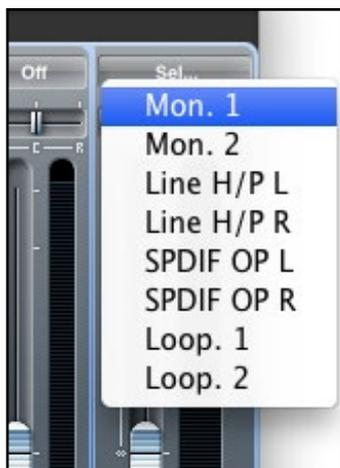
Cliquer sur "Sel..." affichera un menu déroulant de toutes les destinations de sortie disponibles pour le mixage sélectionné. Sélectionnez dans ce menu une sortie de destination pour le mixage sélectionné.
