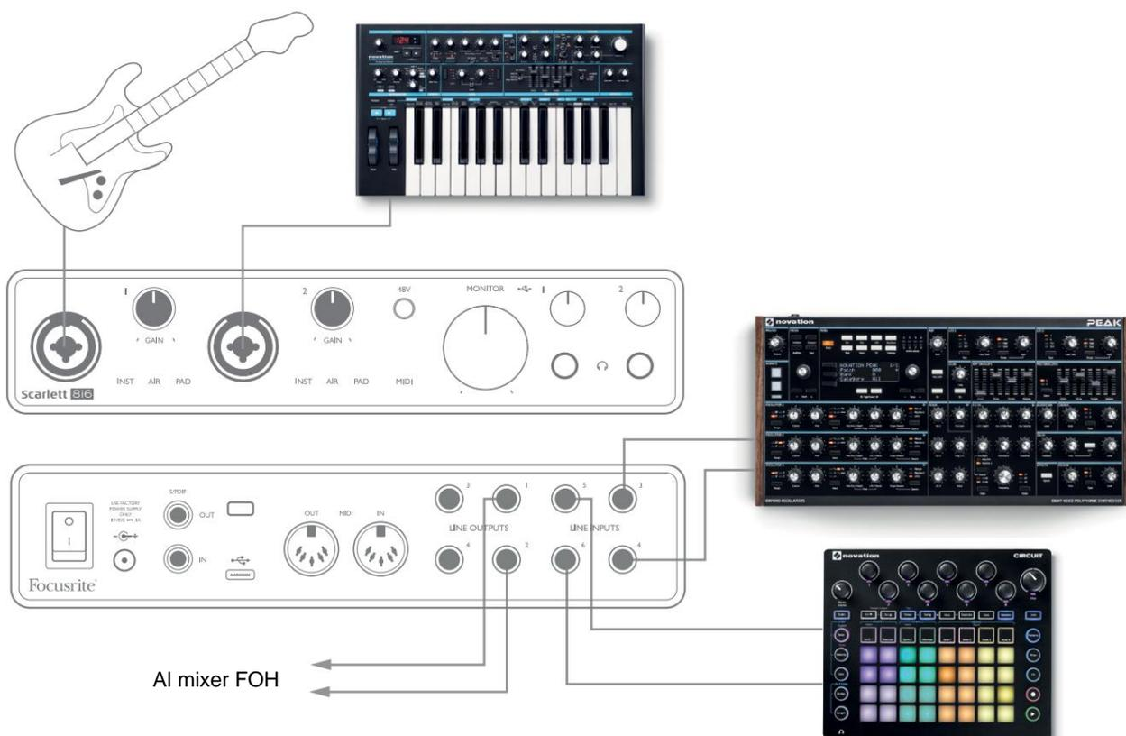
Nell'esempio mostrato, una chitarra, sintetizzatori stereo e mono e un groovebox sono collegati ai sei ingressi analogici della Scarlett 8i6; Le uscite 1 e 2 vanno al sistema PA principale. È possibile impostare un mix approssimativo in Focusrite Control e regolare i livelli delle due sorgenti mono rispetto a quelli stereo dal pannello frontale.
