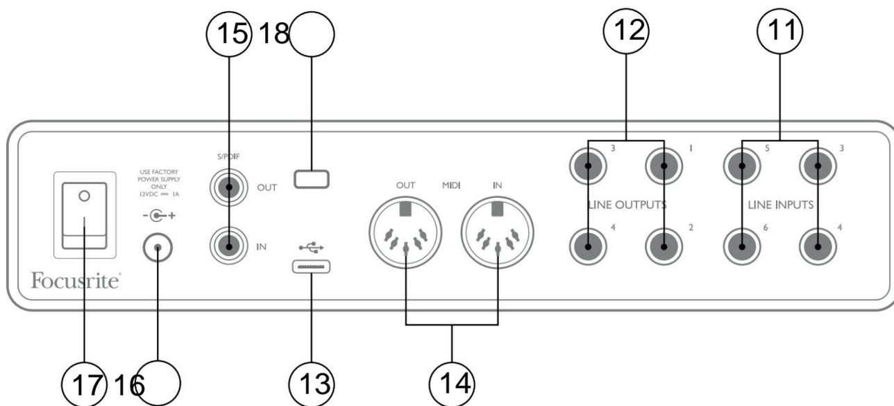
11. **INGRESSI DI LINEA da 3 a 6** – quattro ingressi di linea analogici bilanciati su prese jack da ¼" (6,35 mm). Collegare qui ulteriori sorgenti a livello di linea, utilizzando prese jack da ¼" TRS (bilanciate) o TS (sbilanciate).
