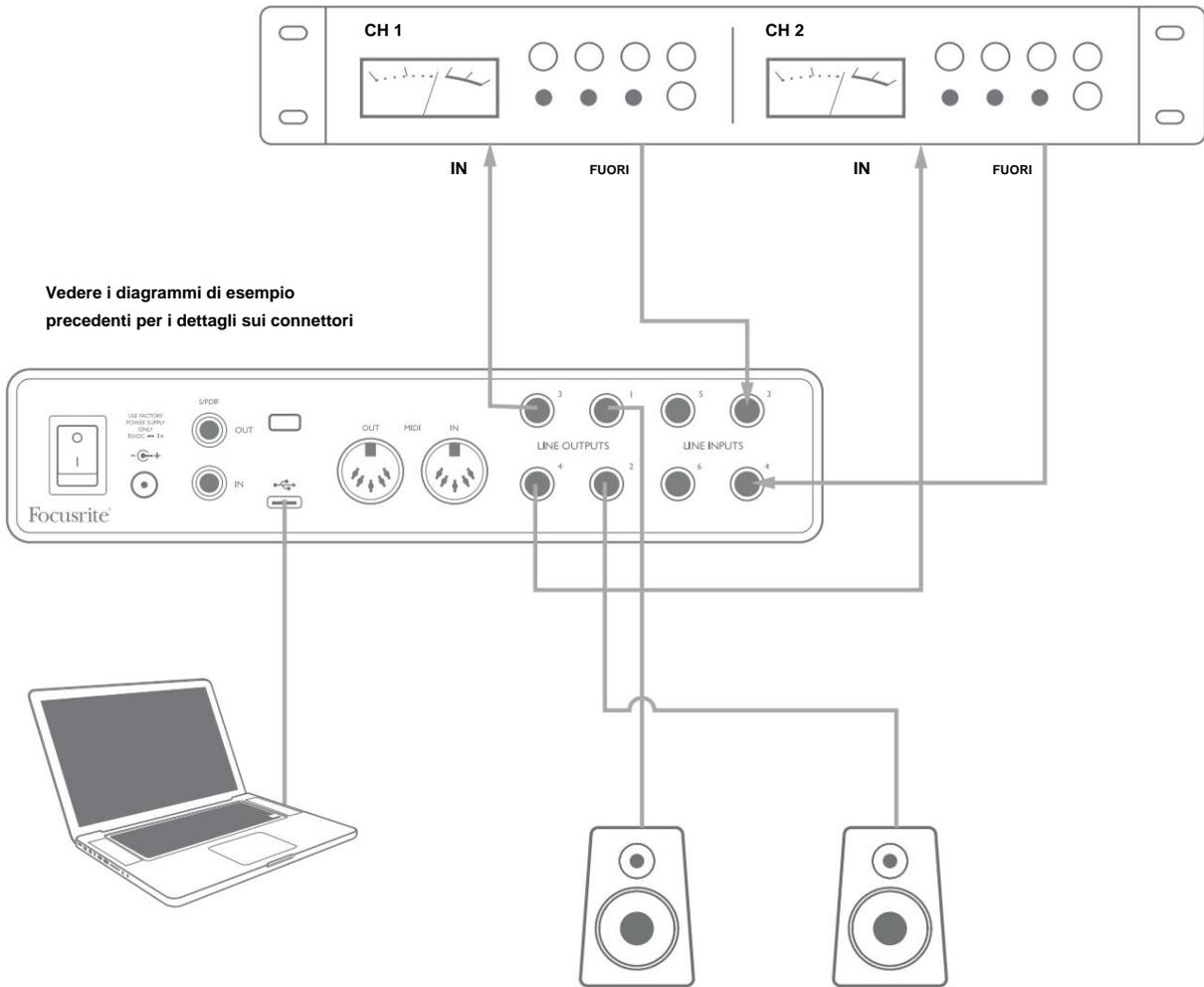
È possibile utilizzare Focusrite Control o il software DAW per regolare i livelli da e verso il processore esterno, se necessario o per effetti creativi.
