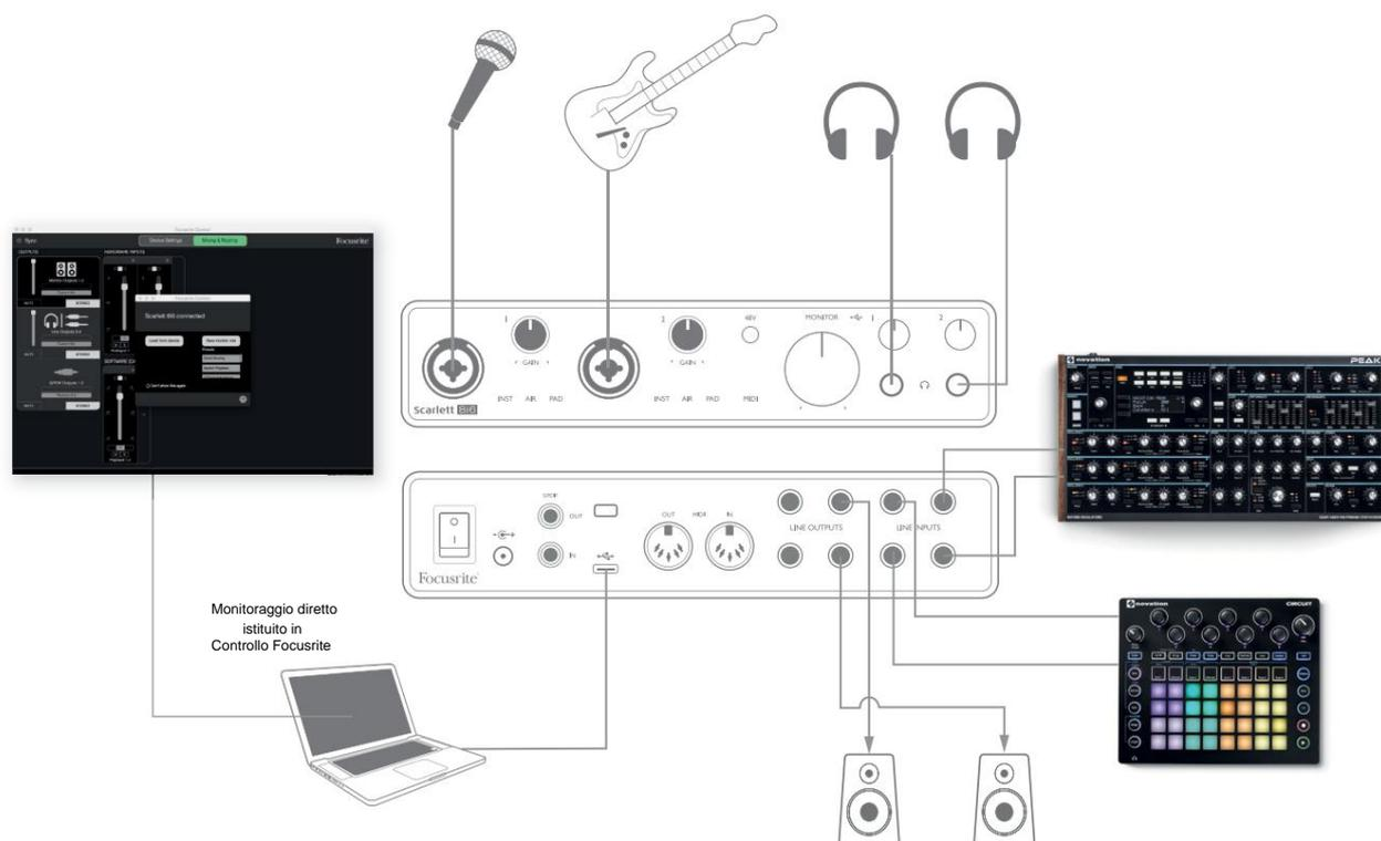
Questa configurazione mostra una configurazione per la registrazione di un cantante e un chitarrista insieme a una tastiera e una drum machine utilizzando il software DAW su Mac o PC. Gli ingressi 1 e 2 sono usati rispettivamente per voce e chitarra, gli ingressi 3 e 4 ricevono l'uscita stereo della tastiera e gli ingressi 5 e 6 sono usati per la drum machine.
