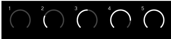
プリアンプに信号を入力しながら入カゲインを調整すると、ゲイン Halo はコンピュータへの送信レベルに応じて緑、橙、赤に点灯します。ゲイン・ノブの位置とゲイン値の関係は上記図と同様となります。ゲイン調整後にノブから手を離すと、通常の入カメーター表示に復帰します (入カメーターのページ参照)。
