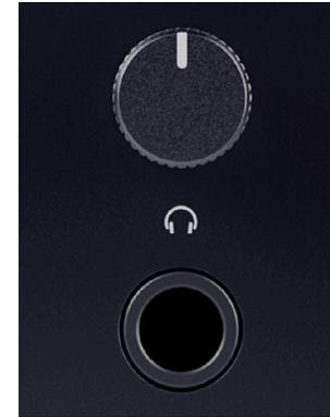
ヘッドフォン出力部は 6.35mm ( 1/4 インチ ) TRS ジャック用となっています。多くのヘッドフォンの端子は 3.5mm TRS ジャックとなっていますが、これらのヘッドフォンを Scarlett 4i4 に接続するには、TRS 6.35mm - 3.5mm 変換アダプターを使用してください。
