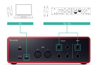
1. 将一条 6.35mm 平衡 TRS 连接线的一端连接到声卡的备用线路输出端口(譬如:通常连接音箱的输出端口 1-2 之外的其他输出端口)。
