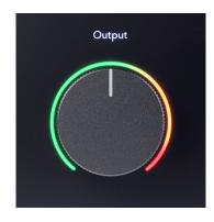
**输出**控制旋钮将输出电平从无(完全逆时针)设置为满量输出(完全顺时针)。
