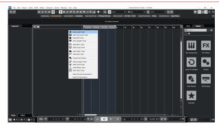
8. 将轨道类型配置为音频并将音频输入设为您在声卡上使用的通道。
