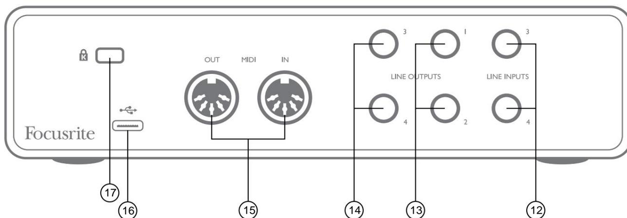
12. **LINE INPUTS 3 e 4** – 2 conectores TRS de ¼"; estas são entradas balanceadas para uso com fontes de nível de linha adicionais, por exemplo, de um teclado, módulo de sintetizador ou unidade FX.
