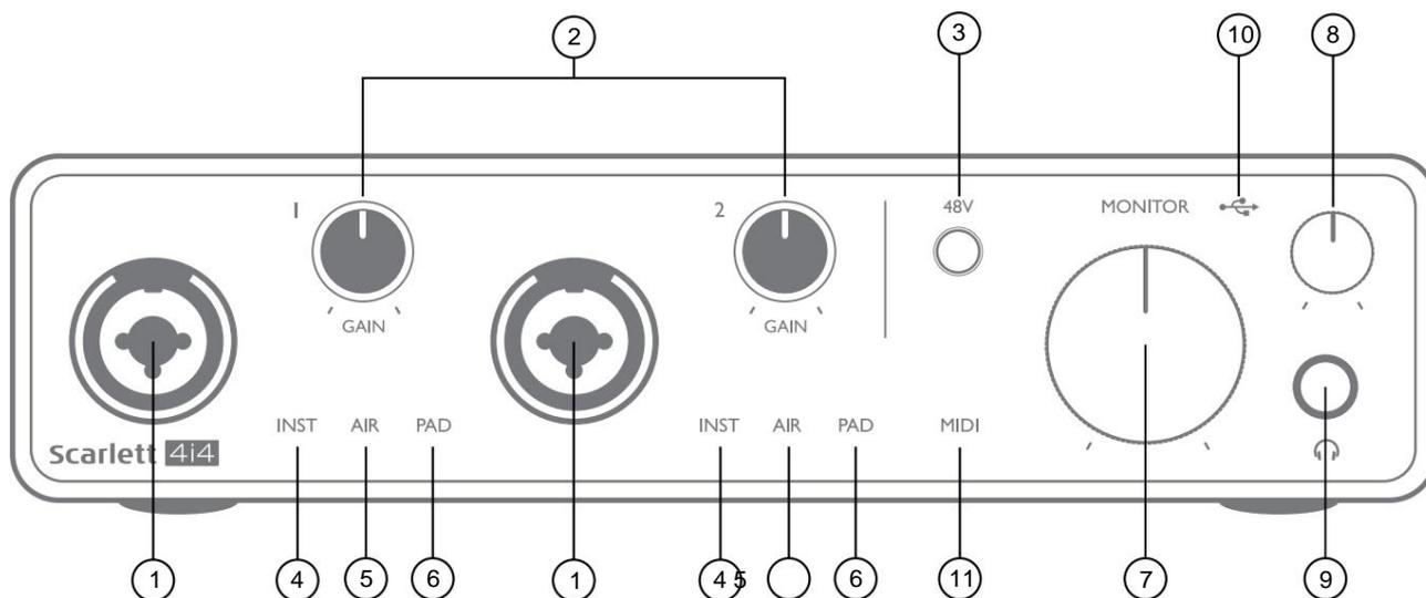
O Painel Frontal inclui os conectores de entrada para sinais de Mic, Linha e Instrumento, bem como o ganho de entrada e controles de monitoramento.
