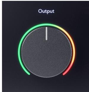
El control de **salida** y el medidor de nivel de salida están relacionados con las señales que van a las salidas 1 y 2 en la parte posterior de su Scarlett 2i2, las salidas que conectaría con mayor frecuencia a los altavoces del monitor.
