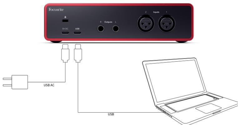
La conexión a su ordenador proporcionará alimentación al USB, comunicación de audio bidireccional y una conexión a Focusrite Control 2.
