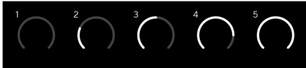
Cuando ajusta su ganancia de entrada mientras envía una señal a su preamplificador, el anillo se ilumina de la misma manera que arriba, pero un color, verde, ámbar o rojo, muestra cuánto nivel está entrando en su ordenador. Poco después de dejar de ajustar la ganancia, los medidores vuelven a los medidores de entrada (consulte Medición de entrada).
