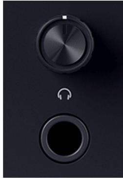
A saída de fone de ouvido é uma tomada TRS de 6,35 mm (1/4"). Muitos fones de ouvido têm uma tomada TRS de 3,5 mm, para conectá-los ao seu Scarlett 2i2 você deve usar um adaptador TRS de 6,35 mm para 3,5 mm.
