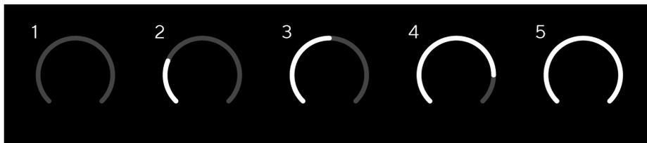
Ao ajustar o ganho de entrada enquanto envia um sinal para o pré-amplificador, o anel se acende da mesma forma que acima, mas uma cor, verde, âmbar ou vermelha, mostra o nível que está entrando no seu computador. Pouco depois de você parar de ajustar o ganho, os medidores são revertidos para medidores de entrada (consulte Medição de entrada).
