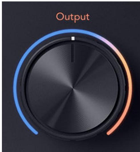
O controle **Output (Saída)** ajusta o nível nas saídas do nada (totalmente no sentido anti-horário) para a saída de escala total (totalmente no sentido horário).
