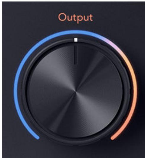
Il controllo **Output** imposta il livello alle uscite da zero (completamente in senso antiorario) al valore di fondo scala (completamente in senso orario).
