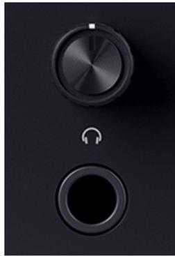
La salida de auriculares es un conector jack TRS de 6,35 mm (1/4"). Muchos auriculares tienen un conector jack TRS de 3,5 mm, para conectarlos a su Scarlett 2i2 debe utilizar un adaptador TRS de 6,35 mm a 3,5 mm.
