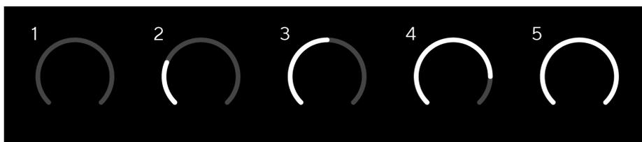
Cuando ajusta su ganancia de entrada mientras envía una señal a su preamplificador, el anillo se ilumina de la misma manera que el anterior, pero un color, verde, ámbar o rojo, muestra cuánto nivel está entrando en su ordenador. Poco después de dejar de ajustar la ganancia, los medidores vuelven a los medidores de entrada (consulte Medición de entrada).
