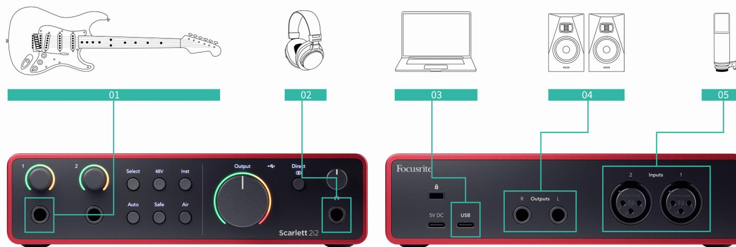
1. Conecte instrumentos como guitarras, bajos, guitarras electroacústicas y otros instrumentos con pastillas a la entrada **1** o **2**, la entrada del conector jack de 6,35 mm del panel frontal. Cuando conecte un instrumento, use un cable de conector jack mono TS de 6,35 mm a 6,35 mm y configure la entrada como "instrumento" con el botón **Inst**.
