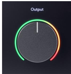
Der Regler für den **Ausgang** und die Ausgangspegelanzeige beziehen sich auf die Signale, die zu den Ausgängen 1 und 2 auf der Rückseite Ihres Scarlett 2i2 gesendet werden, also den Ausgängen, an die Sie Monitorlautsprecher am häufigsten anschließen.
