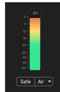
仪表上方的指示器会显示峰值电平读数（以 -dBFS 为单位），即您开始监听输入以来该轨道上的最高电平。将鼠标悬停在该峰值电平表后再点击，可以重置数值。
