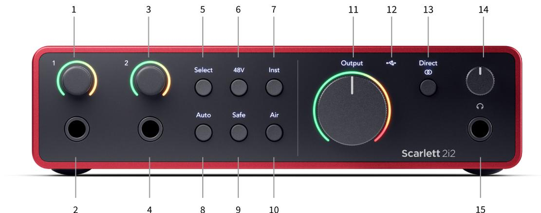
1. 输入 1 的增益控制旋钮和增益光环指示灯 - 增益控制旋钮设置输入电平，而增益光环显示的是 Jack 或 XLR 麦克风输入 1 端口中的输入信号和前置放大器增益电平情况。
