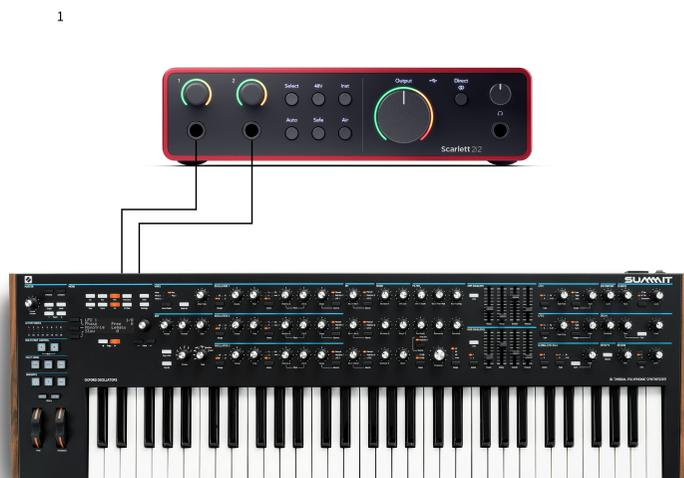
2. 这显示了 Scarlett 2i2 上每个输入端口连接了两个单声道信号源。输入 **1** 端口连接了一个麦克风前置放大器。该麦克风前置放大器将信号增强为线路电平级别，如果您的麦克风前置放大器采用的是 XLR (公) 输出接口，那您仍然需要通过 6.35mm TRS 接口连接 Scarlett（例如：使用 XLR (母) - 6.35mm TRS 转接线）。输入 **2** 连接有单声道合成器，使用的是 6.35mm TRS 连接线。
