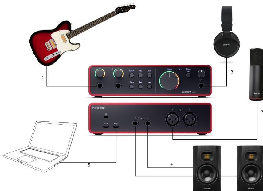
1. 将带拾音器的乐器（如吉他、贝斯、电箱琴）连接到输入 **1** 或 **2** 端口（前面板的 6.35mm 输入插口）。连接乐器时请使用 6.35mm - 6.35mm 的 TS 单声道接口连接线，并将输入类型设为乐器（用 **乐器** 按钮设定）。
