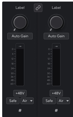
リンクされていない2つのプリアンプ。
