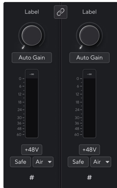
Két összekapcsolatlan csatorna.
