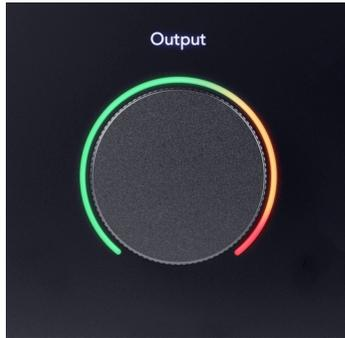
El control **Salida** establece el nivel en las salidas de nada (completamente en sentido antihorario) a una salida a escala completa (completamente en sentido horario).
