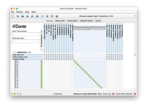
**路由**选项卡排列为交叉点矩阵。音频输入水平排列,称为 Dante Transmitters(发射器);音频输出垂直 排列,称为 Dante Receivers(接收器)。
