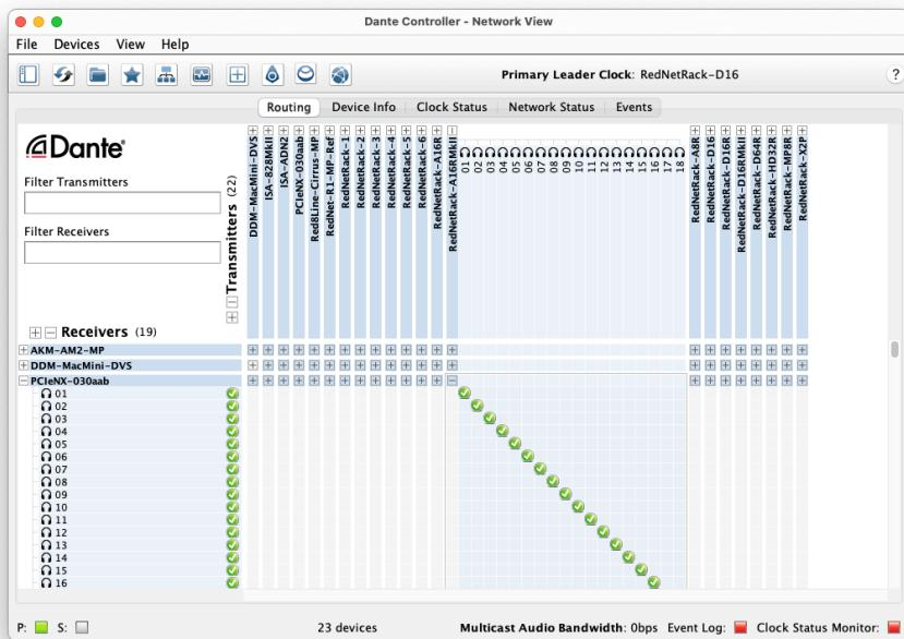
The **Dirijare** fila este aranjată ca o matrice de puncte de încrucișare. Intrările audio sunt listate orizontal (numite transmițătoare Dante) și ieșirile audio sunt listate vertical (numite receptoare Dante).
