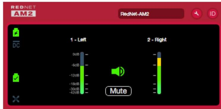
Gornja ilustracija prikazuje RedNet AM2 s neaktivnim Line Out Mute i prikazuje signal prisutan na oba kanala. Imo dostupno PoE napajanje i ima zaključanu mrežnu vezu.
