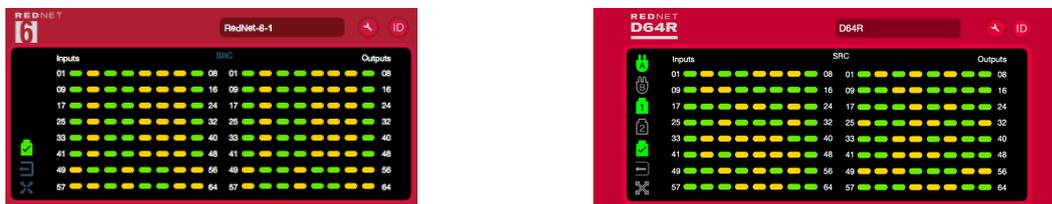
Die Screenshots oben zeigen ein RedNet 6 und ein RedNet D64R mit Signal auf jedem Kanal und einer gesperrten Netzwerkverbindung mit ausgeschalteten SRCs.
