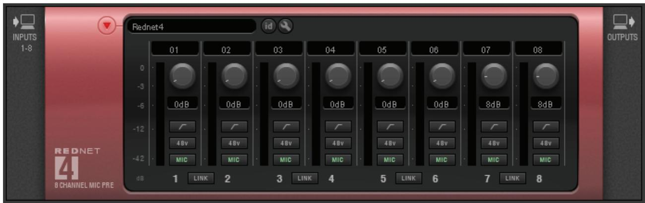
**Metering**（显示仪）：每一通道都带有独立的线性电平显示仪，数值区间为-42 dBFS到0 dBFS。
