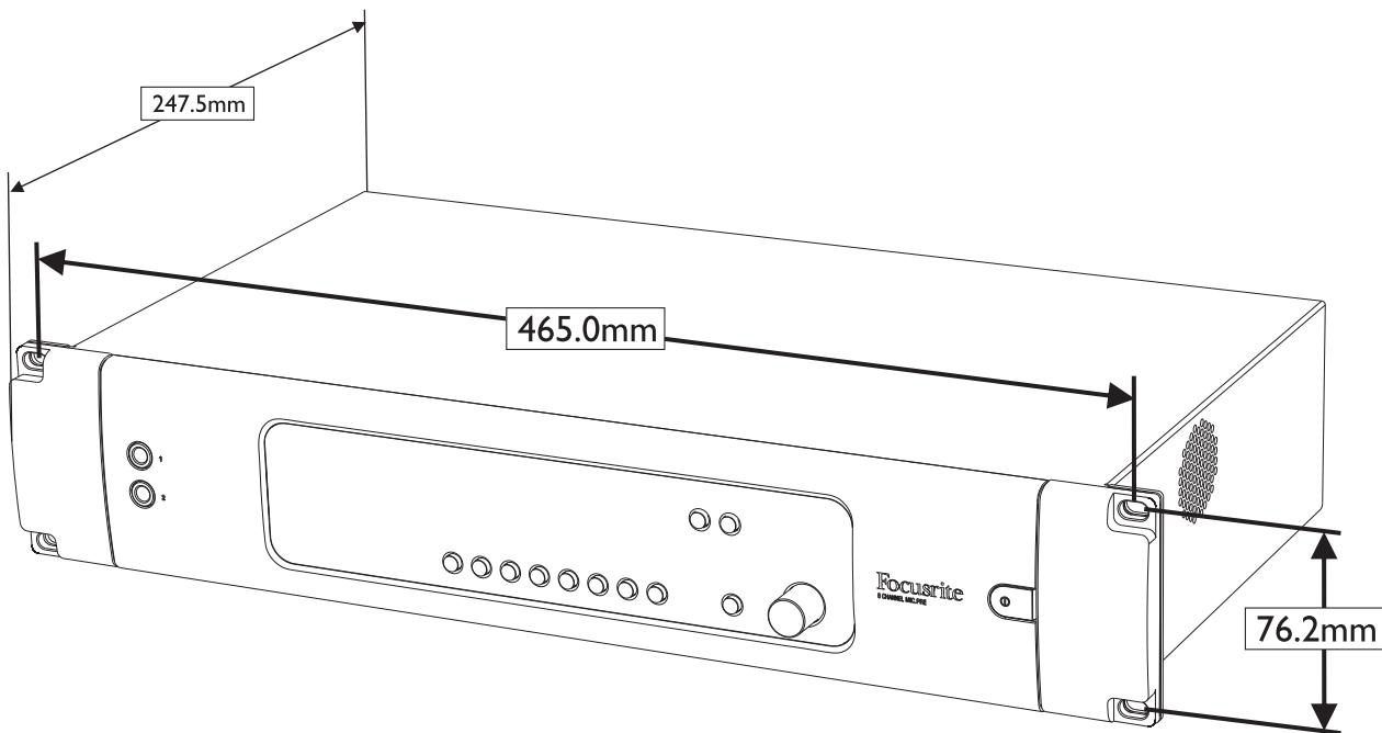
存放RedNet 2需要两个单位的垂直机架，且机架最起码要有350毫米的深度，以给连线留有足够的空间。RedNet 2的重量为4.76公斤，如需要将其安装在一个固定的环境里面 [例如录音棚]，其前面板上的4个螺丝孔可以提供足够的支持，但如果设备的使用处于流动的状态 [例如放在航空箱内做巡演]，则可考虑使用机架两端的固定槽配合螺丝来固定。
