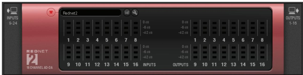
**Metering ( 显示仪 )**：虚拟图像里的每一输入或输出通道都带有3个虚拟的LED指示灯，相应显示设备前面板上三色LED指示灯所显示的电平值，数值分别为 -42 dBFS、-6 dBFS和0 dBFS。
