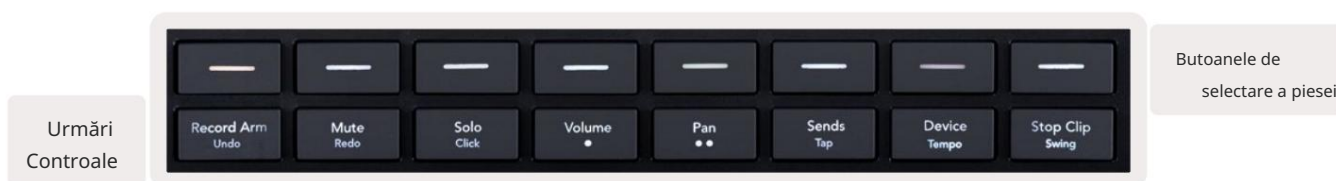
5.4.A – Butoane de selectare a urmăririi și comenzi de urmărire pe Launchpad Pro
