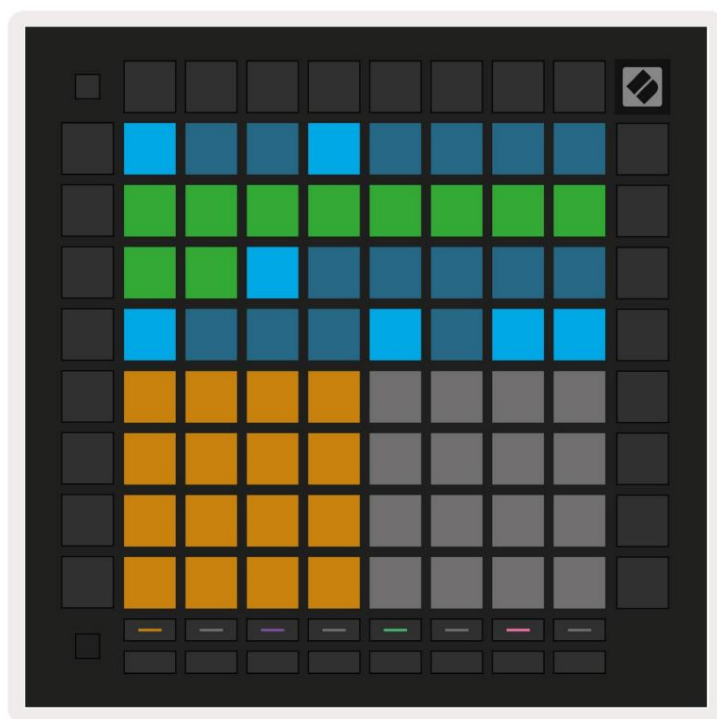
9.2.7.A – Lungimea porții a celui de-al 9-lea pas din acest model este setată la 10 trepte, indicată de cele 10 tampoane verzi
