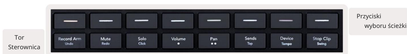
5.4.A – Przyciski wyboru ścieżki i elementy sterujące na Launchpad Pro
