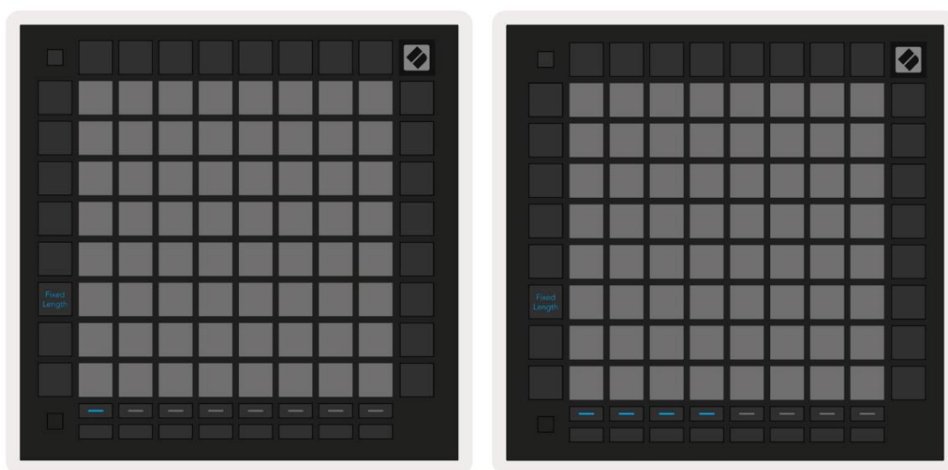
5.3.7.A - Ρύθμιση του αριθμού των ράβδων με το κουμπί επιλογής κομματιού για στ αθερό μήκος. Ένα στ αθερό μήκος 1 ράβδου φαίνεται στην οριζική εικόνα και 4 ράβδοι στα δεξιά.
