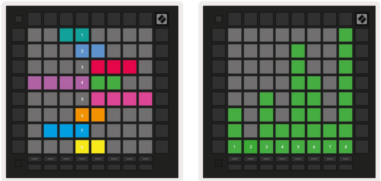
5.4.9.A – Faders για πανοράμια κομμάτια (αριστερά) και ένταση (δεξιά)
