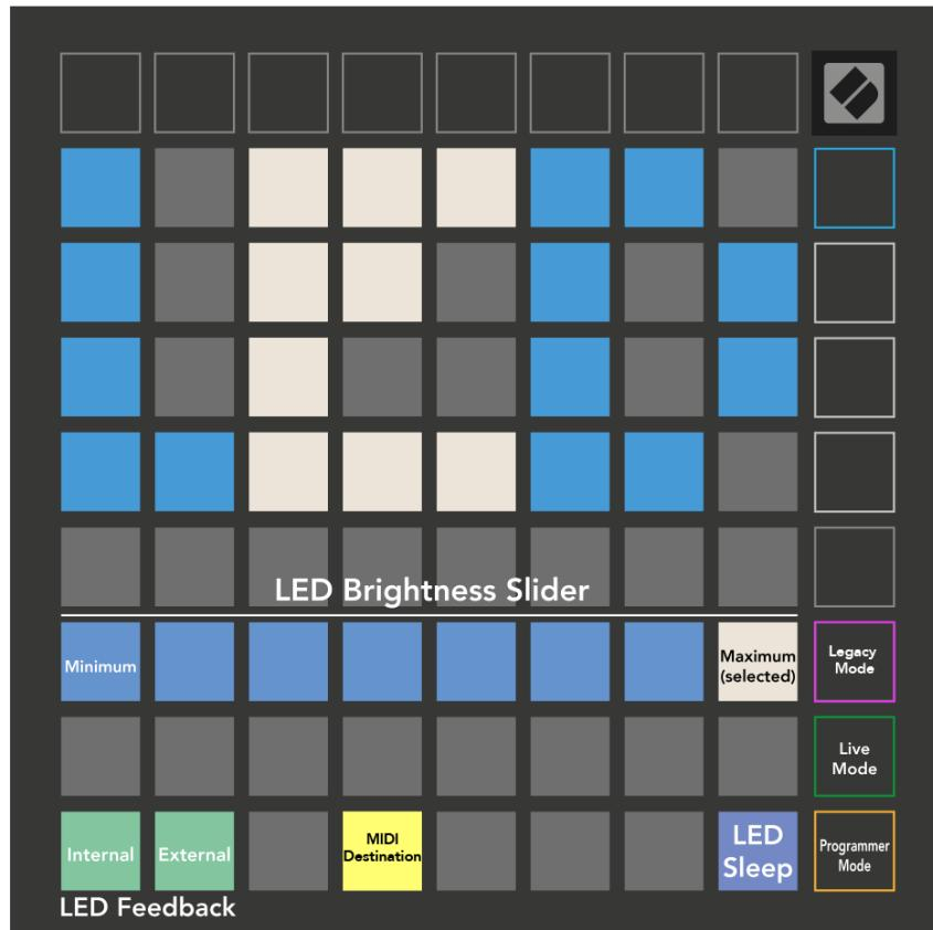
**LED spavanje** može se pritisnuti za isključivanje svih LED dioda Launchpad Mini. Pritisnite bilo koju tipku ili tipku da probudite uređaj. Ovo je korisno kada ga ne koristite Launchpad Mini, ali ga ne želite isključiti.
