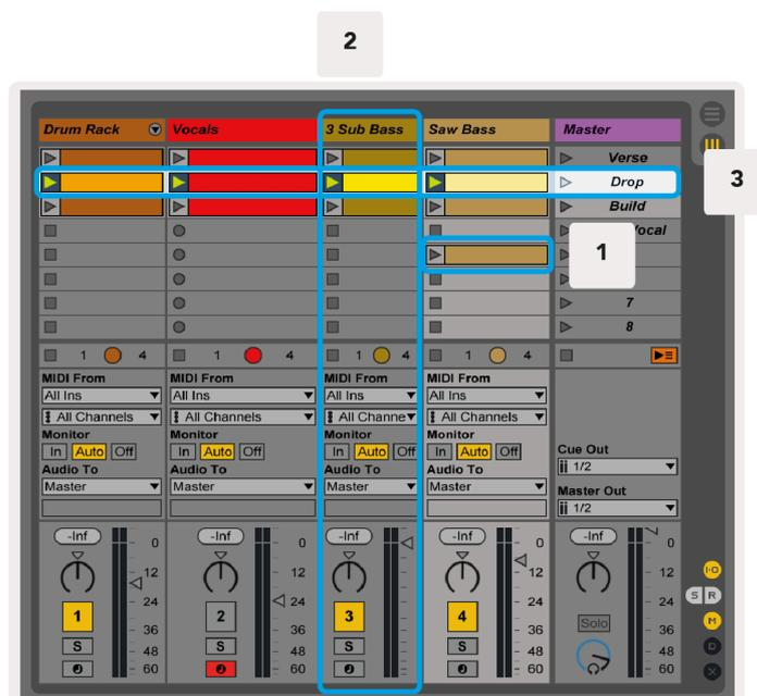
Mit den Tasten ▲▼◀▶ können Sie durch die Sitzungsansicht navigieren. Der rote Umriss im Raster der Sitzungsansicht zeigt den Bereich an, der derzeit sichtbar ist Launchpad Mini.
