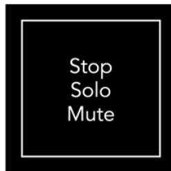
Wenn das Gerät eingeschaltet ist, stellt die untere Reihe zunächst Clips auf die gleiche Weise dar wie der Rest des 8x8-Rasters. Nachdem Sie „Stumm“ hinter sich gelassen haben, werden in der unteren Reihe wieder Clips angezeigt. In diesem Zustand leuchtet die Schaltfläche „Stop Solo Mute“ weiß.
