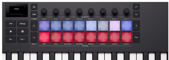
선택된 트랙 및 패드 위 레코드 암 상태를 반영하는 Launchkey Mini 37 패드들
