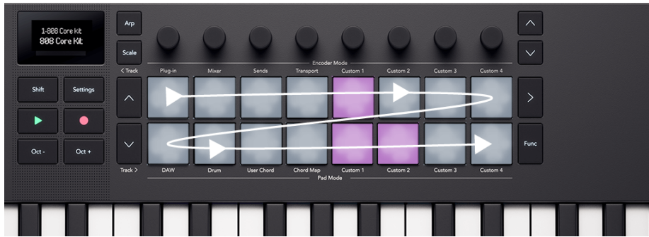
화살표가 있는 패드 레이아웃이 시퀀서의 방향을 표시
