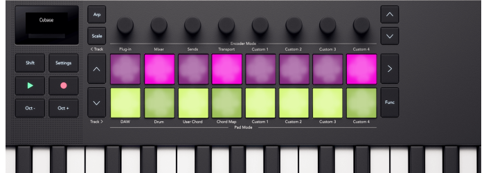
패드들의 믹서 음소거 및 솔로 상태를 반영하는 Launchkey Mini 37 패드들
