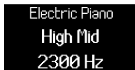
A magas-közép EQ sáv frekvenciájának szabályozása az 5-ös kódolóval.
