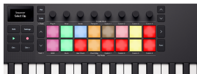
The Launchkeyn tyynt, joissa näkyvät klipit, jotka voit valita. Tyhjät klipsipaikat vaaleanpunaiset.
