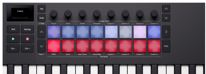
The Launchkey Mini 37 tyynyt, jotka heijastavat raidan valintaa ja tallennusvarren tiloja tyynyillä.
