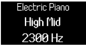
Styring af High Mid-EQ-båndets frekvens med encoder 5.
