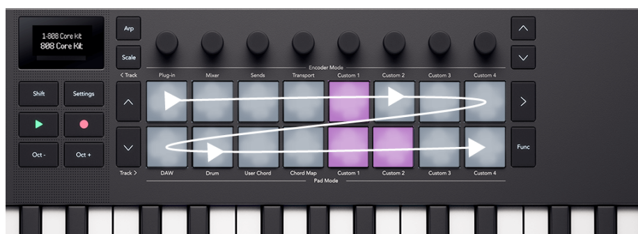
Pad-layout med pile, der viser sequencerens retning
