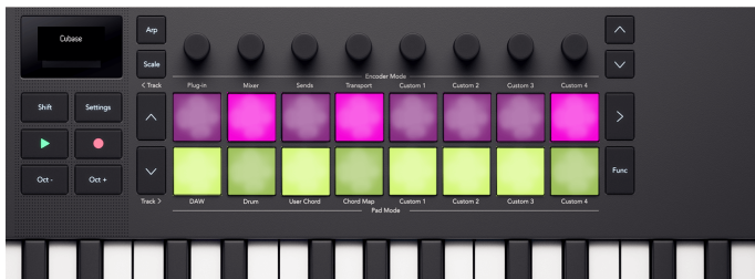
De Launchkey Mini 37 pads som reflekterar mixerns Mute och Solo-tillstånd på pads.
