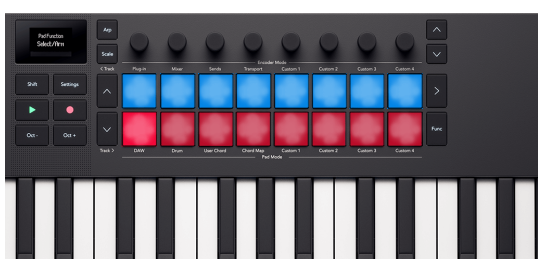
The Launchkeypad-urile lui în modul Select/Armare Logic.
