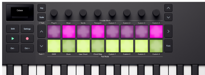
The Launchkey Mini 37 pad-uri care reflectă stările Mute și Solo ale mixerului pe pad-uri.
