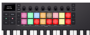
Ten Launchkeypady pokazujące klipy, które możesz wybrać. Puste gniazda klipów świecą na czerwono.
