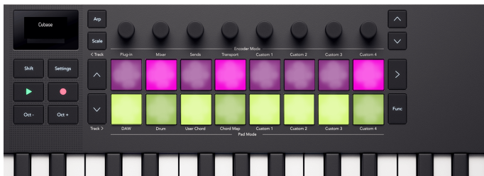
De Launchkey Mini 37 pads die de Mute- en Solo-standen van de mixer op de pads weergeven.
