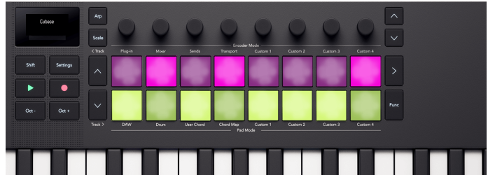
Ο Launchkey Mini 37 τα μαξιλάρια που αντικατοπτρίζουν τις καταστάσεις Mute και Solo του μίκτη στα τακάκια.
