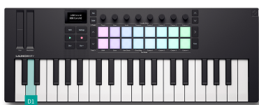
Натискането на LaunchkeyНатиснете клавиша D1, за да изберете песента на малкия барабан.
