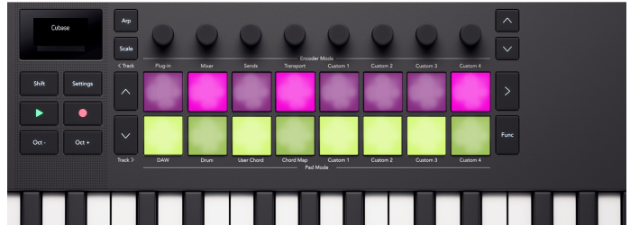
Die Launchkey Mini 37 Pads, wenn sie den Muting- und den Solo-Status des Mischpults anzeigen.
