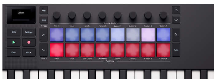
The Launchkey Mini 25 pad-uri care reflectă selectarea pistei și starea brațului de înregistrare pe pad-uri.
