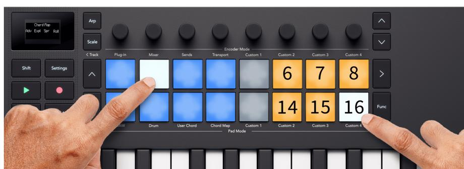
Para usar os pads de performance, segure ou trave um pad de performance à direita, neste caso o Split: Left and right (Divisão: Esquerda e Direita) e pressione um pad de acorde para reproduzir esse acorde com o elemento de performance.
