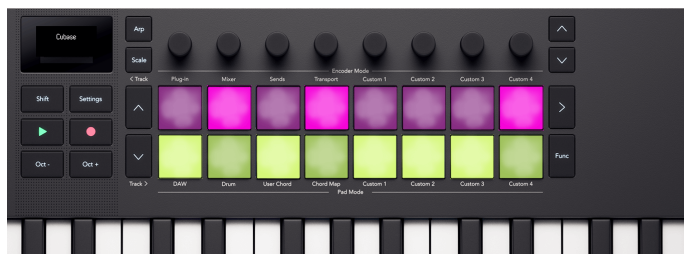
De Launchkey Mini 25 pads die de Mute- en Solo-standen van de mixer op de pads weergeven.
