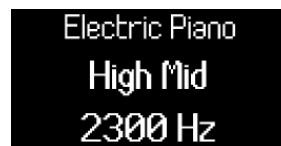
Regelen van de frequentie van de High Mid-EQ-band met encoder 5.
