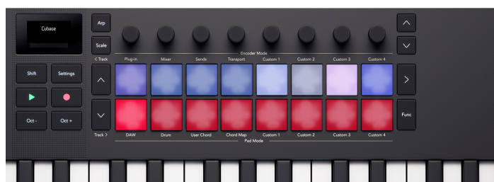
De Launchkey Mini 25 pads die de status van de trackselectie en opnamearm op de pads weergeven.
