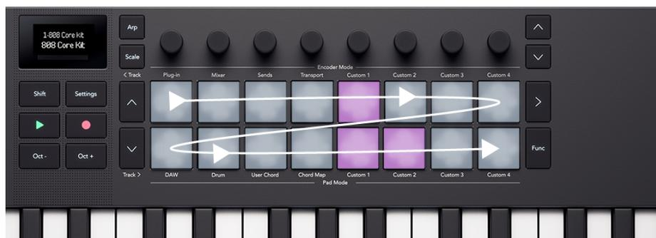
Disposition du pad avec des flèches indiquant la direction du séquenceur
