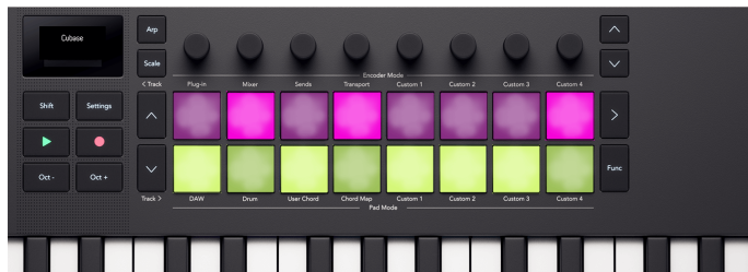
The Launchkey Mini 25 spilventiņi, kas atspoguļo miksera Mute un Solo stāvokļus uz spilventiņiem.
