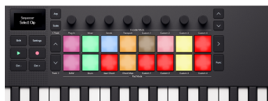
The Launchkeys spilventiņi, kuros redzami klipi, kurus varat atlasīt. Tukšas klipu spraugas gaiši sarkanas.
