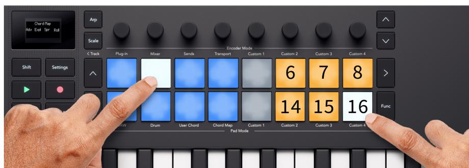
Per utilizzare i pad di esecuzione, tieni premuto o blocca un pad di esecuzione sulla destra, in questo caso Split: Left and right, quindi premi un pad di accordi per suonare quell' accordo con l'elemento di esecuzione.
