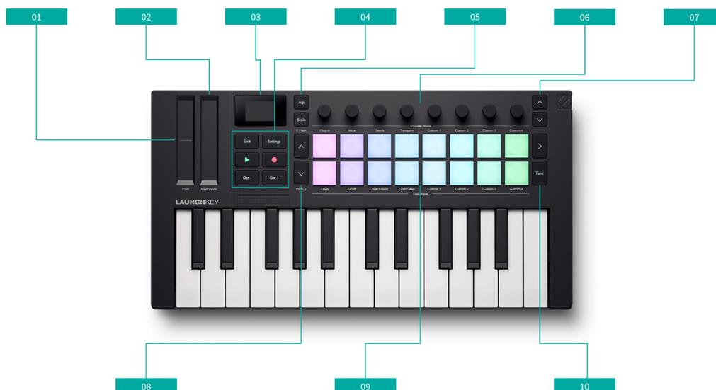
1. Pitch Touch strip - altera l'intonazione delle note che stai suonando e invia messaggi di pitch bend.
