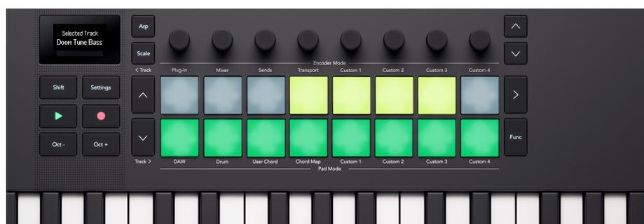
La riga inferiore del pad Launchkey Mini 25 attiva le scene Live Loops di Logic.
