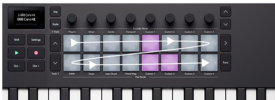
Layout del pad con frecce che mostrano la direzione del sequenziatore
