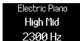
Anzeige bei Änderung der Frequenz des High Mid-EQ-Bereichs mit Enkoder 5.
