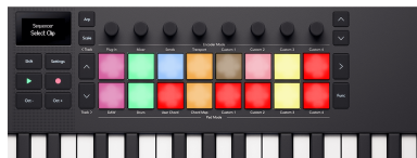
Die Pads des Launchkey, wie sie die auswählbaren Clips anzeigen. Nicht mit Clips belegte Pads leuchten hellrot.
