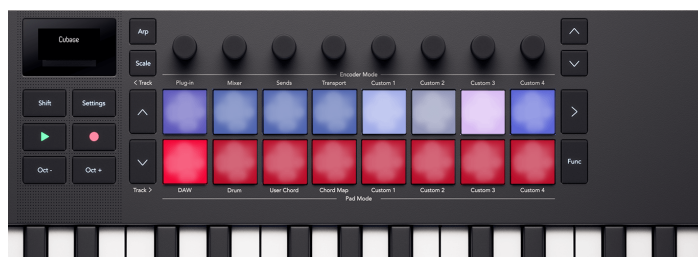
Die Launchkey Mini 25 Pads, wenn sie den Track-Auswahl- sowie den Aufnahmebereitschaftsstatus anzeigen.
