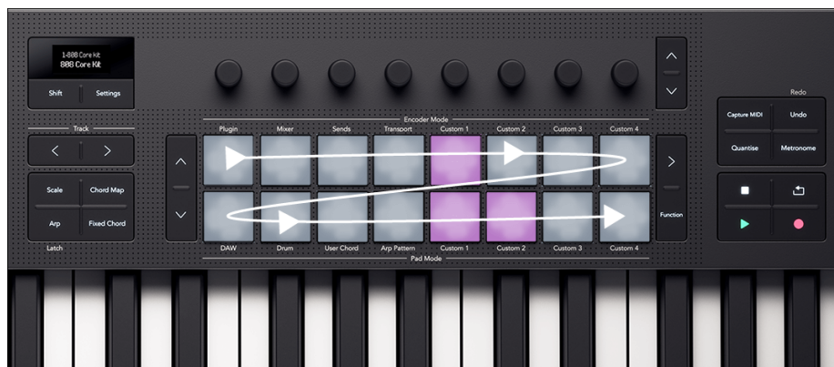
Pad-layout med piler som viser retningen til sequenceren
