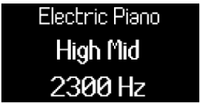
Contrôle de la fréquence de la bande High Mid-EQ avec l'encodeur 5.
