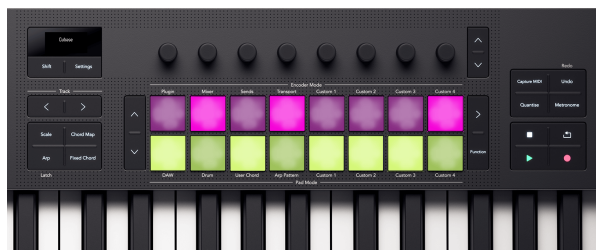
Die Pads des Launchkey 88 zeigen die Mute- und Solo-Zustände des Mixers an.
