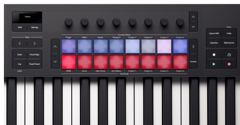
Die Pads des Launchkey 88 zeigen den Track-Auswahl- und Aufnahmebereitschaftsstatus auf den Pads an.
