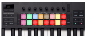
Die Pads des Launchkey zeigen die auswählbaren Clips an. Leere Clip-Slots leuchten rot.
