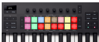
Die Pads des Launchkey, wie sie die auswählbaren Clips anzeigen. Nicht mit Clips belegte Pads leuchten hellrot.
