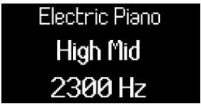
Ovládání frekvence pásma vysokých a středních tónů ekvalizérem pomocí enkodéru 5.
