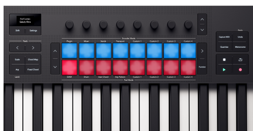
Launchkey 的打击垫在 Logic 的 Select/Arm 模式下的状态。
