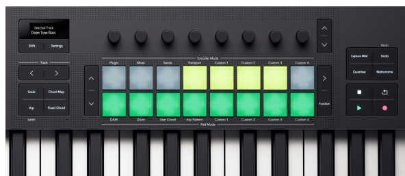
打击垫会显示与 Loop 循环一致的灯光颜色。
