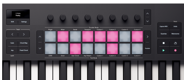
Launchkey 的打击垫代表了音序器中的音符。
