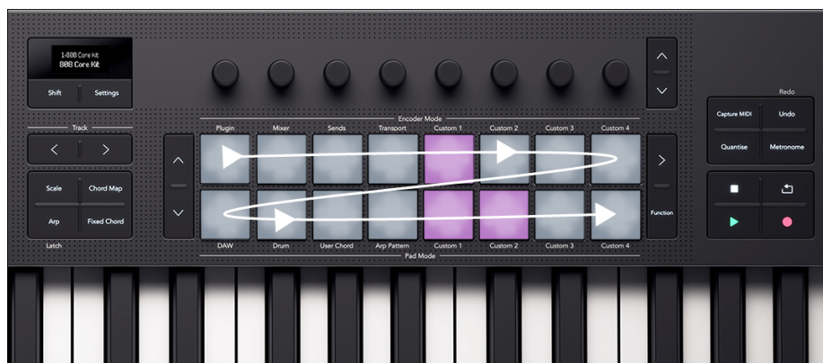
带箭头的打击垫布局显示的是音序器行进的方向
