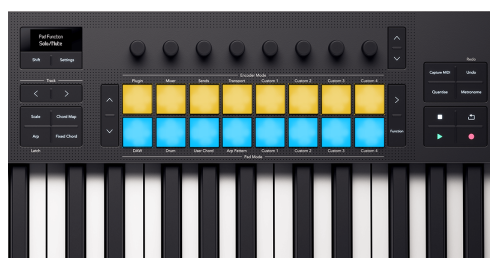
Launchkey 的打击垫在 Logic 的 Solo/Mute 模式下的状态。
